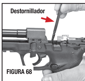
Vista desde la parte superior: Biela del resorte del retén del cargador dentro de la muesca
