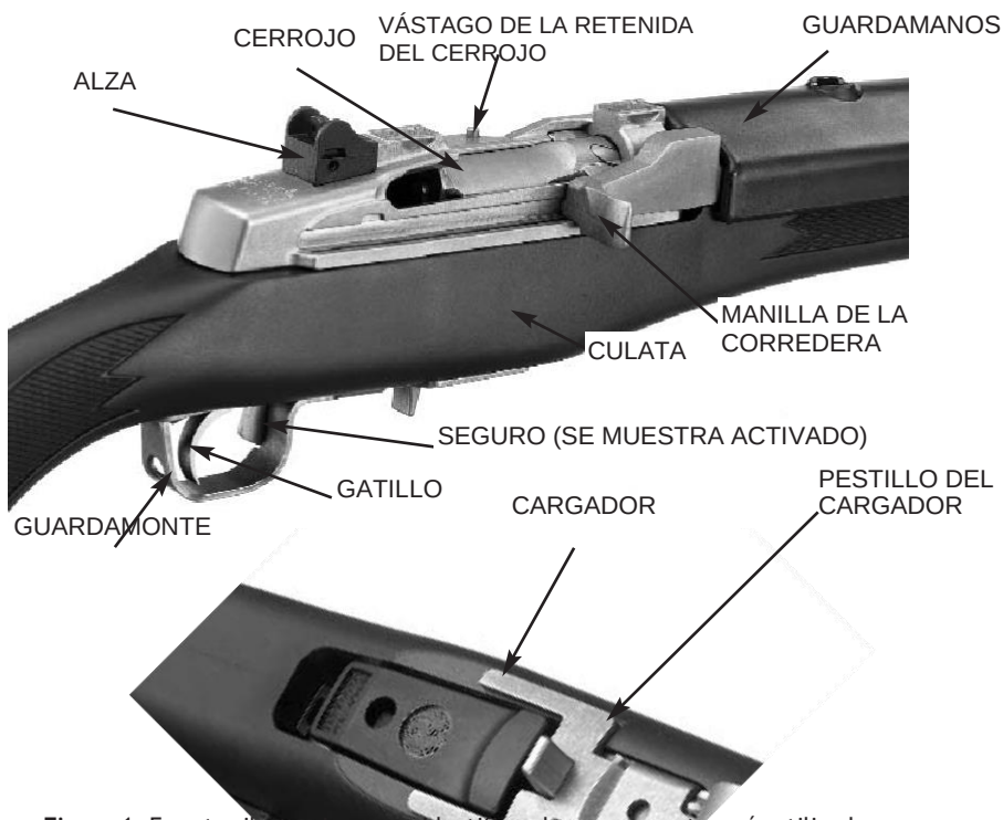
Figura 1. En estas ilustraciones, se identifican los componentes más utilizados. Fíjate en que el seguro está hacia atrás del borde delantero del guardamonte, por lo que está en posición «ON» (seguro).
