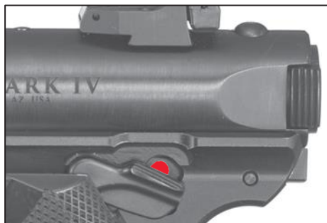
Figura 4. Seguro en posición «OFF» o «FIRE» (desactivado). El seguro se encuentra abajo del todo y se observa el punto rojo .
